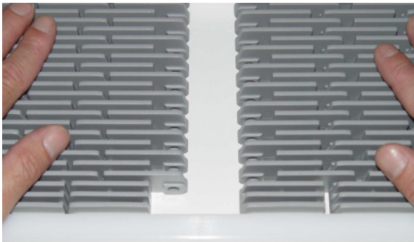
Avvicinare le sezioni del nastro
