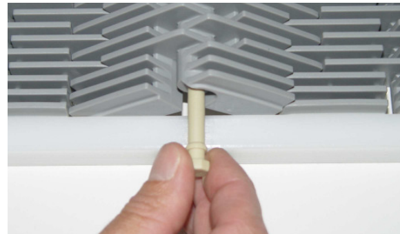
Inserire il perno. Per agevolare l'installazione, l'estremità del perno deve essere smussata.
