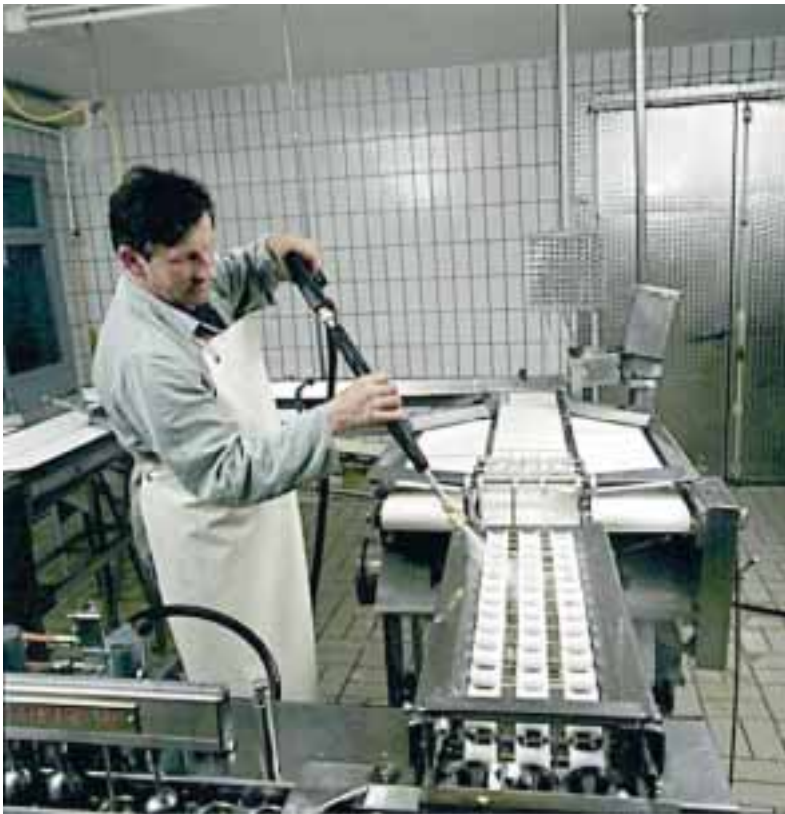
食品搬送用ベルトの低圧洗浄
